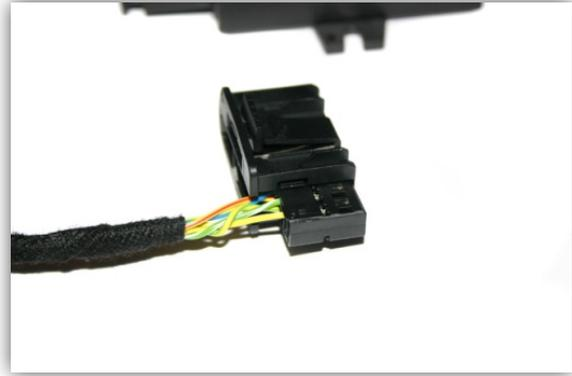
Komplette Buchse in den Stecker auf der Rückseite des Navigationsmonitors einstecken. Den 8-Pin Molex-Stecker des TV-BMWE65 mit der CAN-Box TV-401 verbinden.
