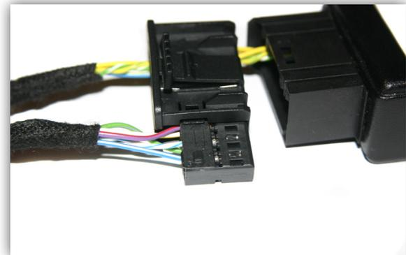
Komplette Buchse in den Kabelsatz TV-BM65 einrasten.
