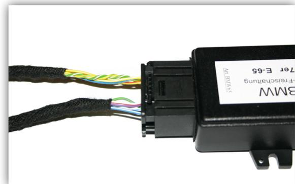
12-poligen Einsatz des Kabelsatzes TV-BM65 in die schwarze Buchse des Fahrzeugkabelbaumes einschieben.
