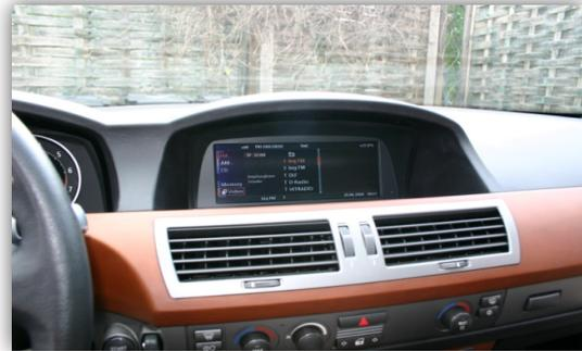
Die 3 TORX-Schrauben oben am Monitor lösen.
