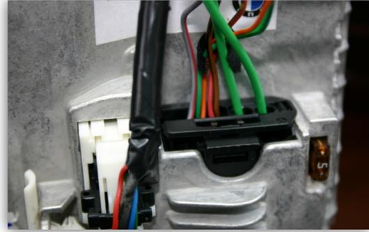
12-poligen Einsatz aus schwarzer Buchse des Fahrzeugkabelbaumes entriegeln.
